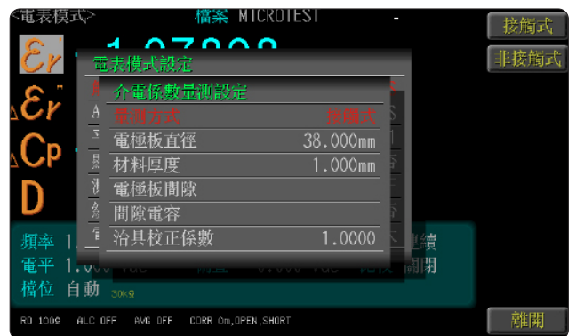
介電治具 使用介電常數測試治具 FX-0000C7，儀器內建公式直接算出材料介電數值 \epsilon_r' 、 \epsilon_r'' 。評估 PCB 空板或陶瓷板等。
